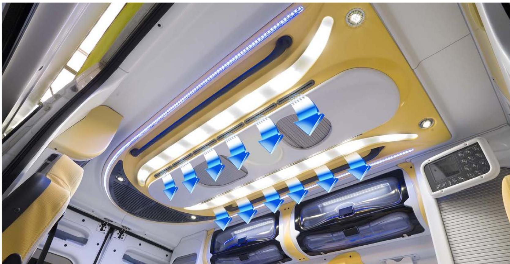
**SANICLIMA impianto di disinfezione del comparto sanitario integrato nell'evaporatore.
